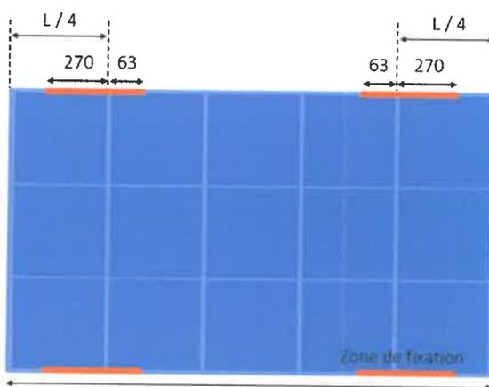
La zone de fixation des modules, ou zone de serrage, est l'endroit où les modules photovoltaïques sont fixés sur les rails JORISOLAR OPTI'ROOF.
